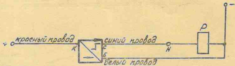
Рис. 2 Схема подключения переключателей типа БВК 260-24, БВК 261-24, БВК 262-24, БВК 263-24, БВК 264-24, БВК 265-24
