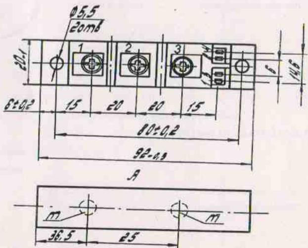
$m$  – контрольные точки измерения температуры корпуса (в круге радиусом 5 мм)
