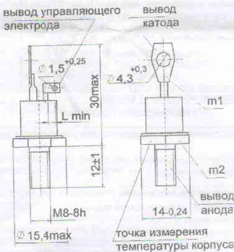
Lmin = 1,7 мм – длина пути тока утечки между выводом анода и выводом управляющего электрода,
