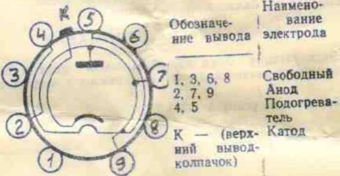
Обозначения выводов даны при рассмотрении лампы со стороны ножки
